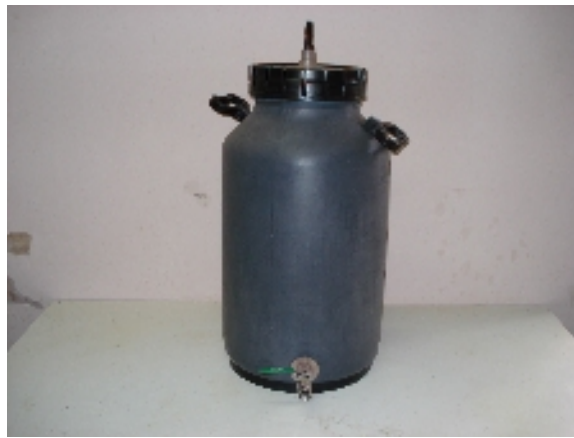
Figura 3: Tanque de fermentação em PVC alimentício
